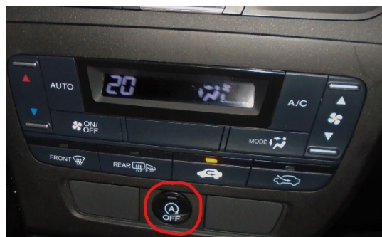
Слика 11. Тастер за укључивање старт-стоп системом
