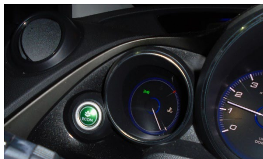
Слика 10. Дугме за укључивање економичног режима вожње
